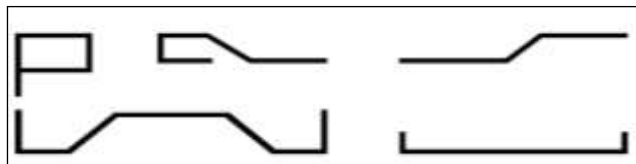
Рис. 5 Формы изгиба арматуры
